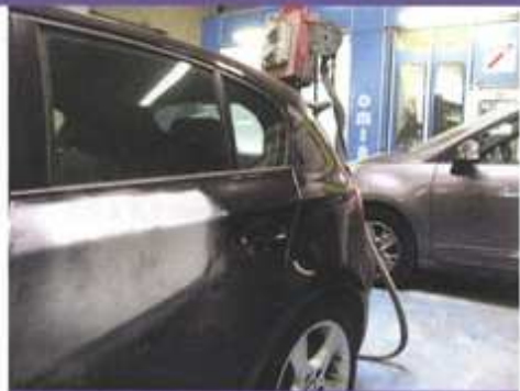
Pour réduire les risques de défauts, la technique du raccord noyé est utilisée.
