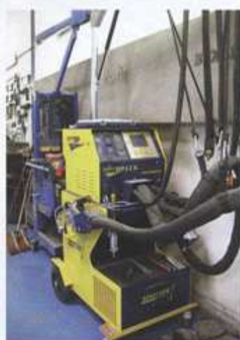
L'investissement dans ce poste de soudure n'est pas négligeable. Il a pourtant été nécessaire, pour pouvoir intervenir sur des tôles à haute limite élastique.
