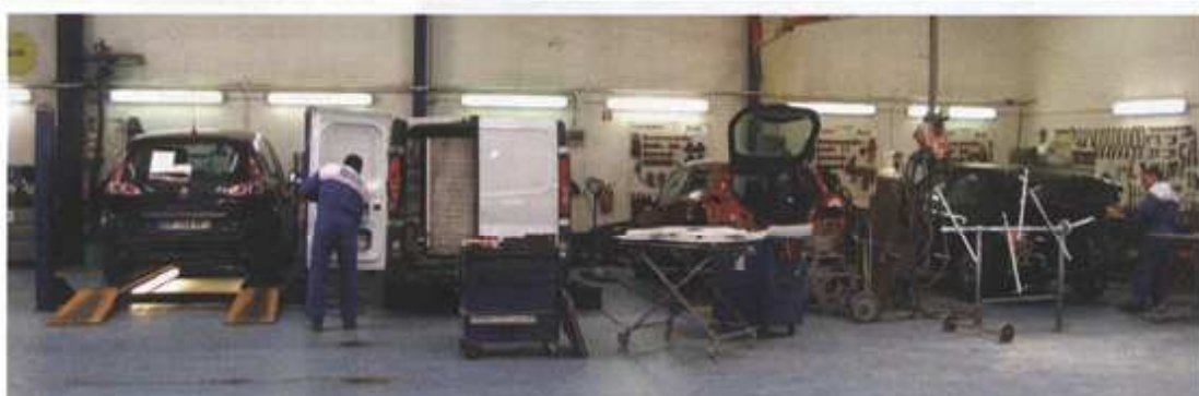
Les tôliers au travail. Tous les postes sont équipés d'une table élévatrice, qui permet de lever la voiture à 80 cm du sol.
